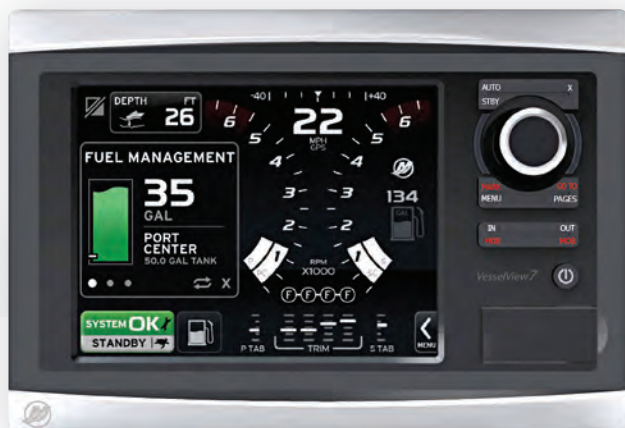
VesselView 7 Monitor für bis zu vier Motoren
