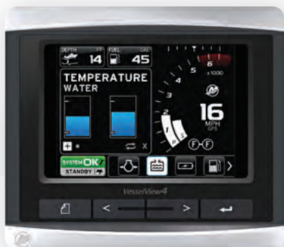
VesselView 4 Monitor für bis zu zwei Motoren
